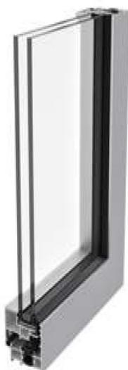
Ventana de oscilobatiente con montaje interior fijo. Serie RS65 con RPT de Exlabesa, con acristalamiento cámara de Argón 4 bajo emisivo/C/6.
